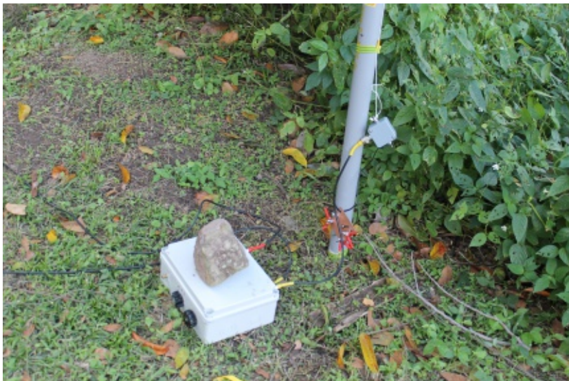
Skrzynka fazująca verticale i zmieniająca pasma
