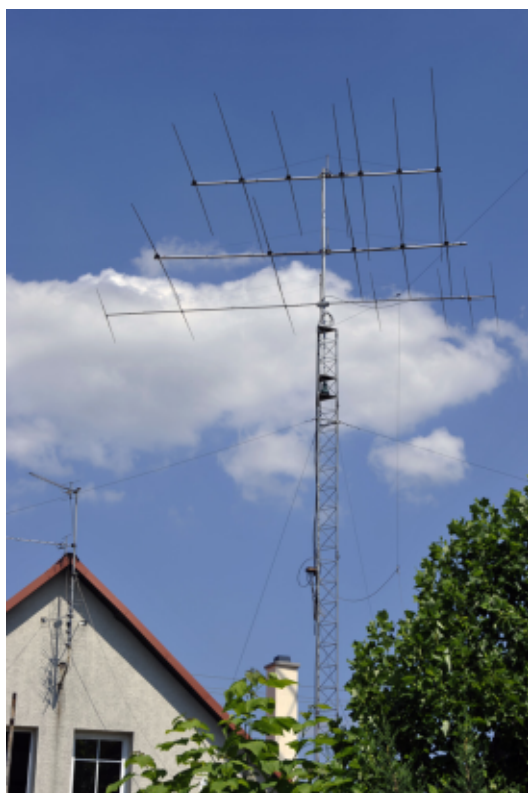
Główny maszt antenowy stacji SP6T z jednopasmowymi antenami
