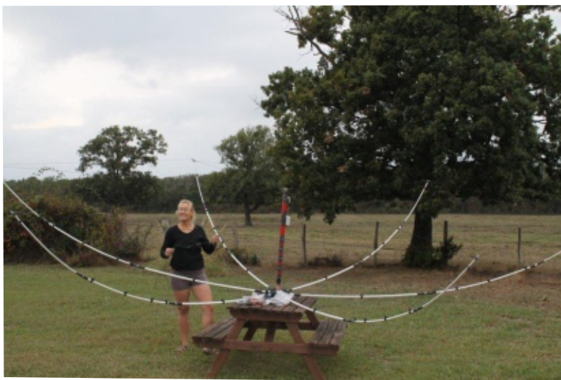
Kasia SQ7OYL. Montaż Hex Beam'a
