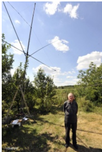
Obracana kierunkowa antena na 3.5 MHz o nazwie Flag jest już gotowa
